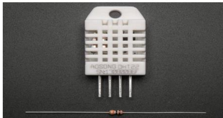
FIGURA 10 – Sensor de umidade relativa e temperatura DHT22 e um transistor
