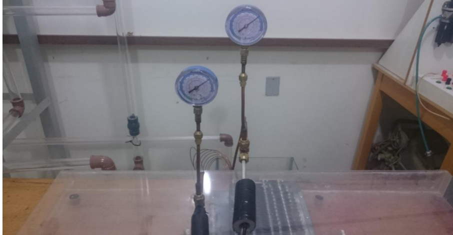
FIGURA 20 – Manômetros instalados na entrada e na saída do evaporador.
