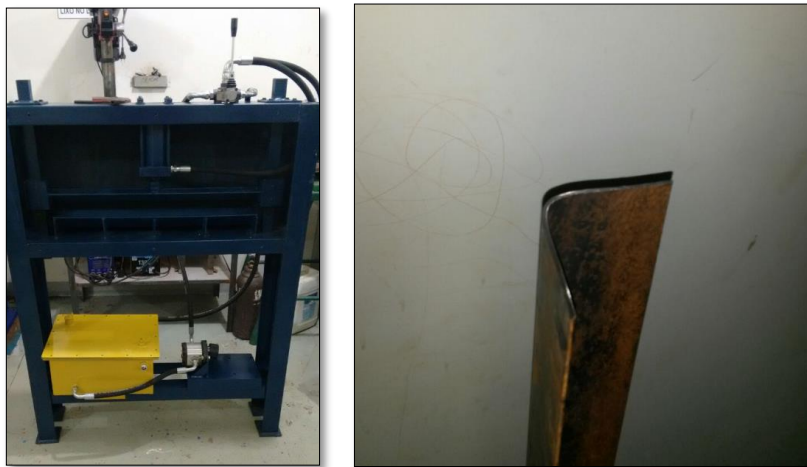
FIGURA 8 – Projeto prensa hidráulica e chapa dobrada
