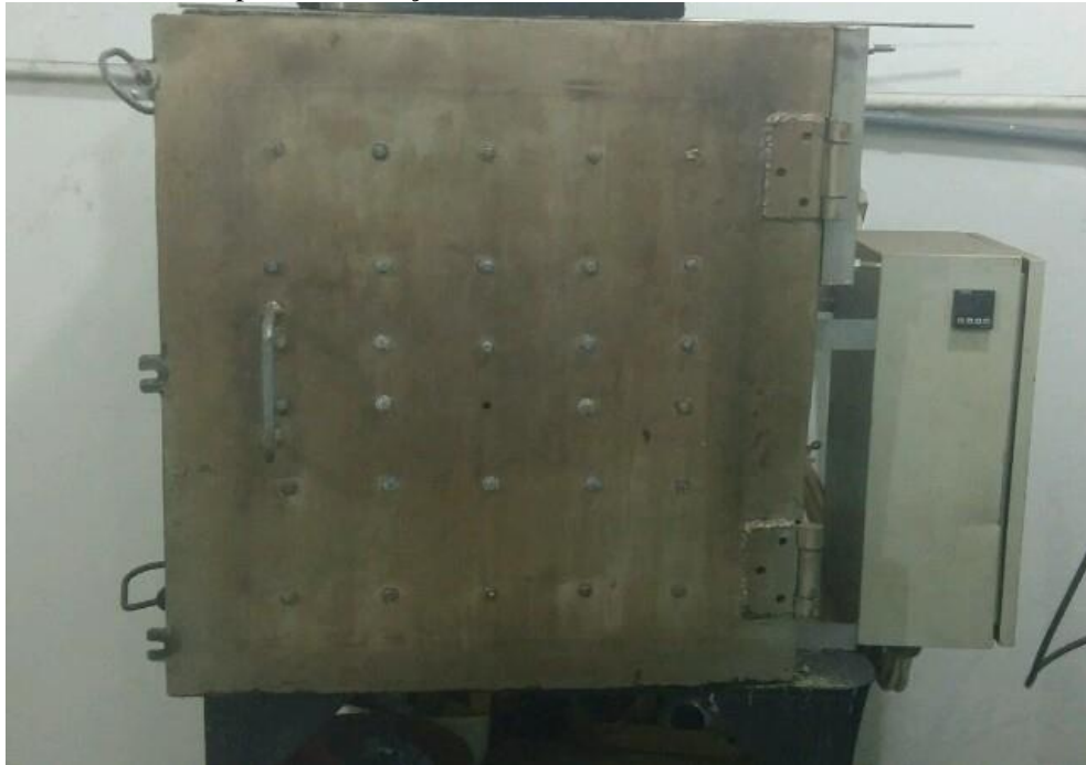
FIGURA 1 – Forno usado para a realização dos tratamentos térmicos
